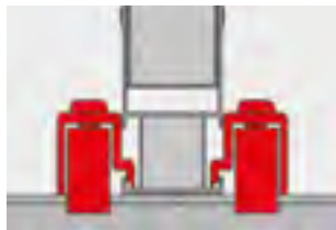
Dreiecksbefestigung bei quer laufenden Grundschielen durch Kreuzschielenverbinder.
