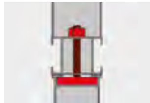
Dreiecksbefestigung bei längs laufenden Grundschielen durch Hammerkopfschraube.
