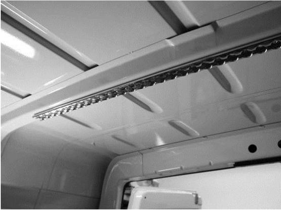
Stahlzurrschienen an den oberen Holmen montieren, dazu Zurrschienen vorbohren mit  $\varnothing$  5,0mm und mit sechs Nieten 5,0x12 an den Holmen befestigen
