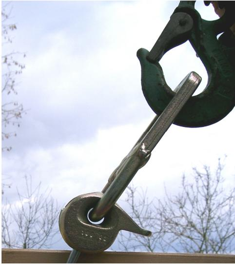
**Bild 1:** Transportankersystem mit DEHA Universal-Kupplung
