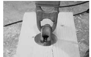
Profondeur de fraisage : 30 mm
