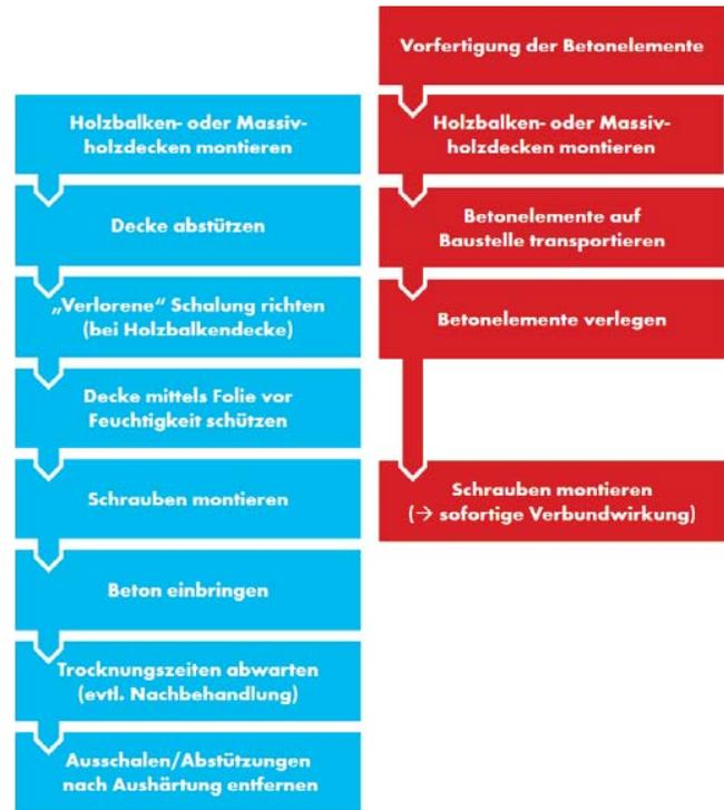
Verlegen/Montieren einer Fertigteilplatte mit FT-Verbindern auf Brettstapelelementen
